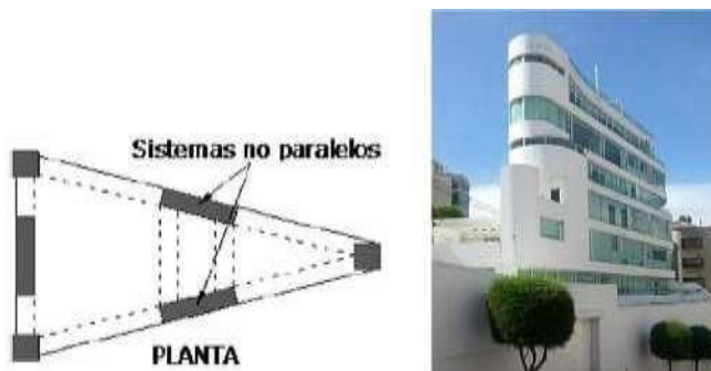
Figura 28 Irregularidad en planta: ejes estructurales no paralelos
