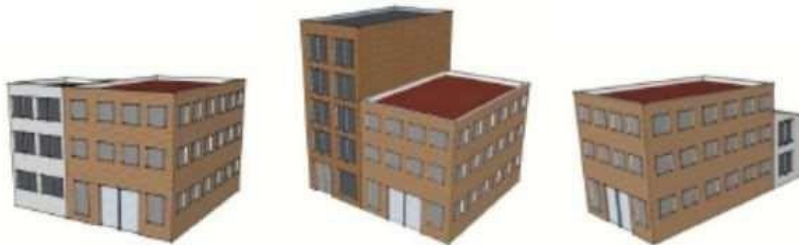
Figura 30 Irregularidad en planta: adiciones
